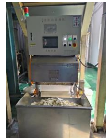
⑥ 塗装スラッジ除去機の導入
