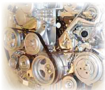
エンジンに取り付けられたプーリー
