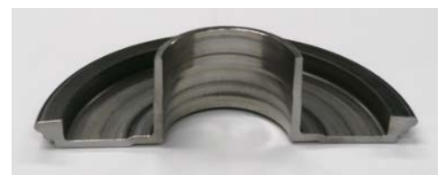
ミッション部品 (外周部を回転成形法で素材の約2倍に増肉)
