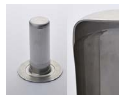
ステンレスサンプル品 (1 mm→0.2 mm 素材の約80%減肉)
